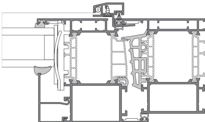
Horizontaler Querschnitt - Insektenschutz für Flügel
